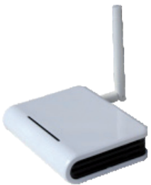
INTERNETMODUL FLEXISMART (GATEWAY)* zur Kommunikation mit dem FlexiSmart-Regler
